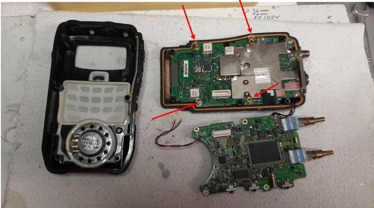
Als nächstes ist die Zentrale Befestigungsschraube (gelber Pfeil) zu entfernen, sowie die beiden Schrauben für den Haltewinkel der beiden Encoderregler (blaue Pfeile), sowie die Schraube links vom Antennenanschluss (roter Pfeil)
