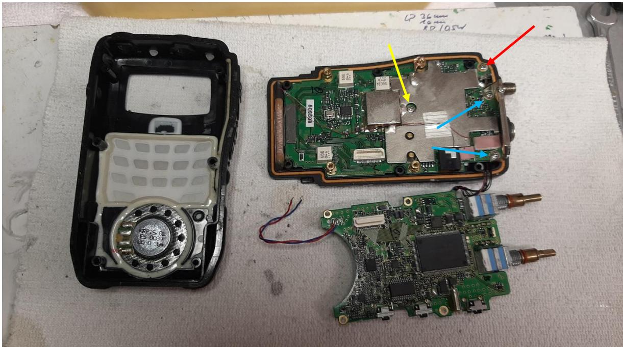
Bei dem hier demontierten Gerät war der Antennenanschluss an der Leiterplatte gebrochen. Um einen weiteren Schaden an der Platine ausschließen zu können, wurde diese völlige Demontage notwendig.
