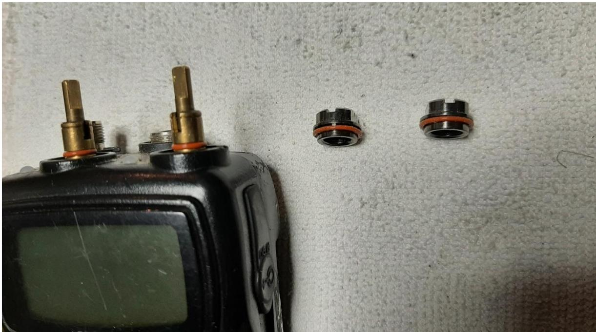
Nun ist die vordere Gehäuseschale unten anzuheben und nach oben über die beiden Encoderregler vorsichtig abzuziehen. Dabei unbedingt auf die kleine Ferritantenne unten achten, damit diese nicht herausfällt und die dünnen Drähtchen abreißen! (nächstes Bild)
