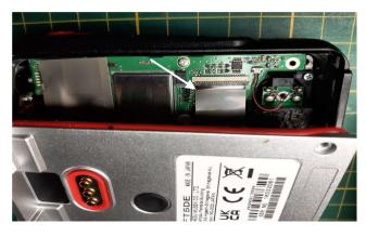
Flexband von der Kontaktleiste entfernen (weißer Pfeil), dazu die schwarze Sicherungsleiste von der Kontaktleiste hochziehen.
