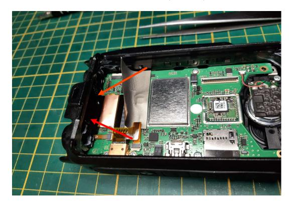
Dann kann der Encoder komplett mit dem GPS-Modul vorsichtig herausgenommen werden (linkes Bild) und anschließend den Encoder von dem Flexkabel vorsichtig entlöten (sechs Lötpunkte). Ich habe hier mit einer Entlötpumpe gearbeitet. Dünne Entlötlitze sollte aber auch funktionieren...
