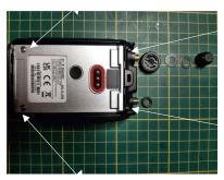
Schraubring von der Antennenbuchse lösen und Dichtring entfernen, der komplette Schraubring vom Encoder wird später erst entfernt.
